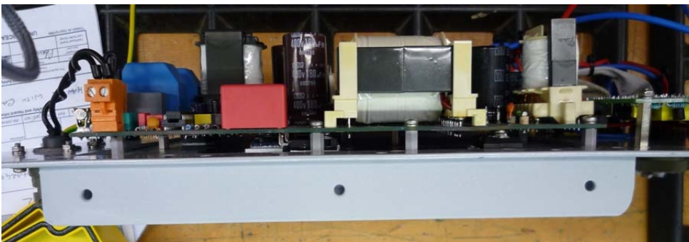
Abb. 17: Leistungsbauteile auf Kühlkörper
